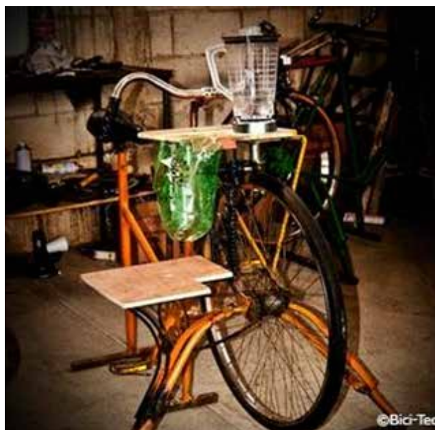
Figura 5: bicimáquina para triturar frutas. Fonte: Bici-Tec. Disponível em: https://meioseculodeaprendizagens.blogspot.com/2018/09/bicimaquinas-revolucao-do-pedal.html
